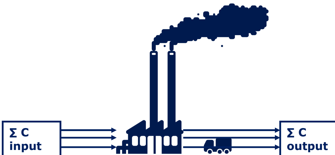
Figuur 3: Principe van massabalansmethode voor het berekenen van de emissies
